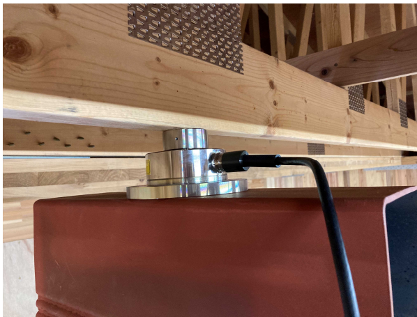
写真 1.3.3 荷重計の設置
