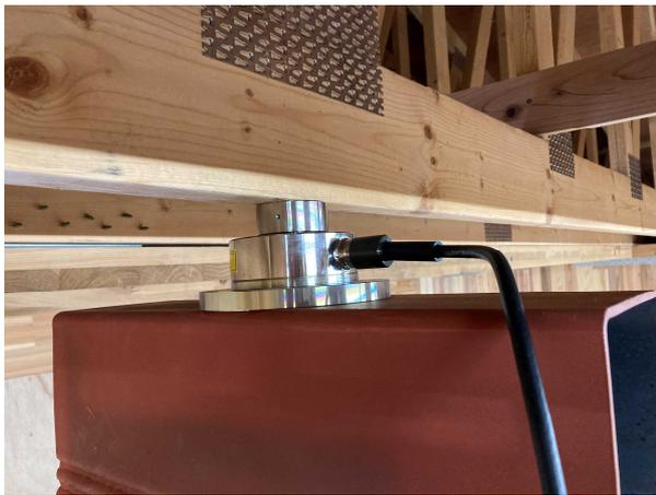
写真 1.3.3 荷重計の設置
