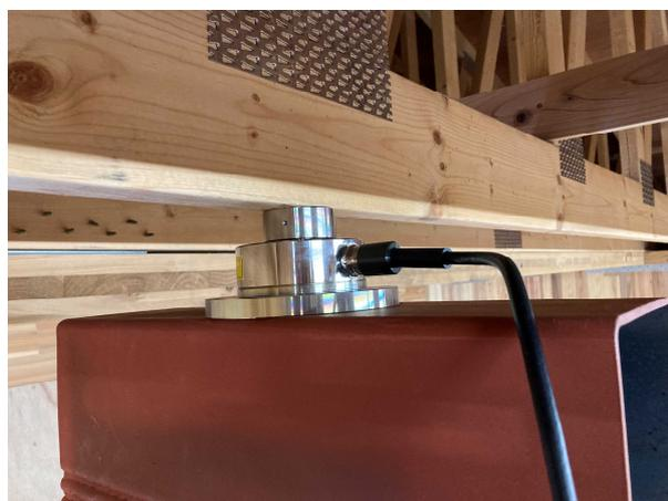
写真 1.3.3 再掲 荷重計の設置
