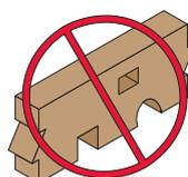
切り欠き、又は穴開けは構造計算で安全が確認されない限り禁止してください。
